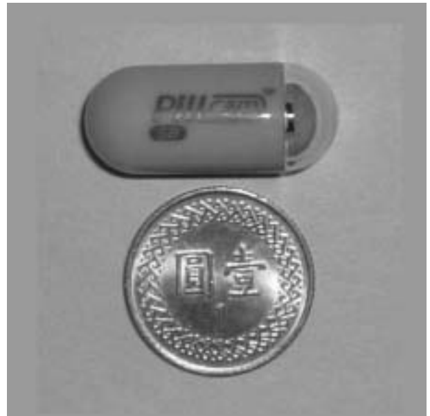
圖二：膠囊內視鏡之直徑1.1公分，長度2.6公分，約只有壹圓硬幣大小。
